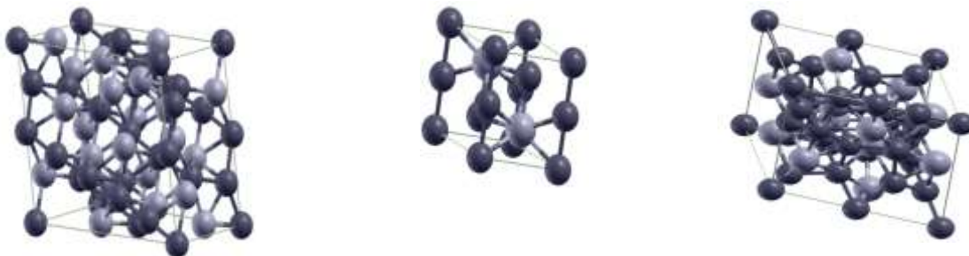
Figura 1. Estructuras cristalinas de las FIs estudiadas: a) \delta -Cu 7 In 3 , b) \eta -Cu 2 In y c) \eta -Cu 6 Sn 5 . En negro átomos de Cu, en gris átomos de In o Sn.
