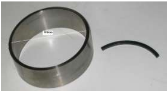
Figura 1. Corte de tubo de presión y perfil de la probeta para los estudios de fisuración diferida por hidrógeno, FDH (izq.). Dimensiones de la probeta (der.) en milímetros.
