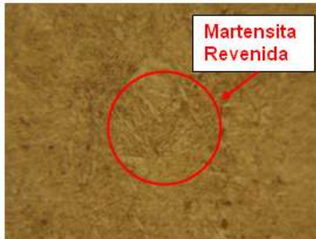
Figura 7. Microestructura del acero SAE 5160
