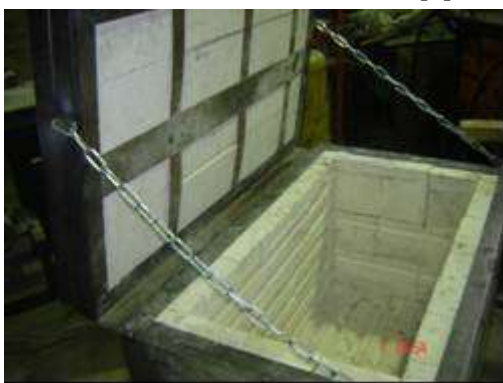
Figura 3 a) Horno de sales utilizado para la simulación de la temperatura de bobinado, b) Plancha con la termocupla en su interior siendo templada en el horno.
