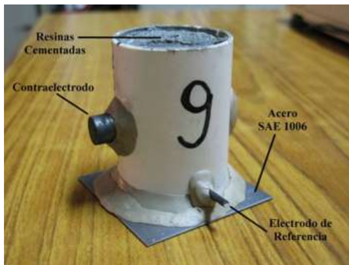
Figura 1. Probeta para la determinación de parámetros electroquímicos del acero en contacto con los residuos cementados.
