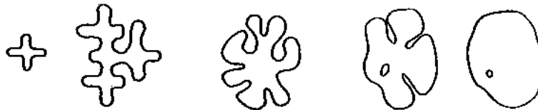
Figura 1. Evolución microestructural de dendrita a roseta [2].
