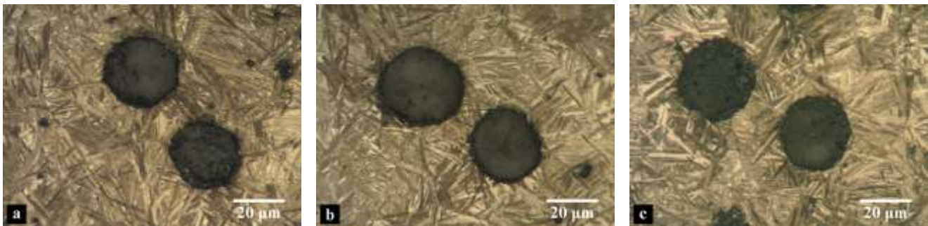
Figura 2. Microestructura de los sustratos antes y después de la deposición: (a) ADI280 494nod/mm 2 , (b) TiN300-ADI280 494nod/mm 2 , (c) TiN280-ADI280 494nod/mm 2
