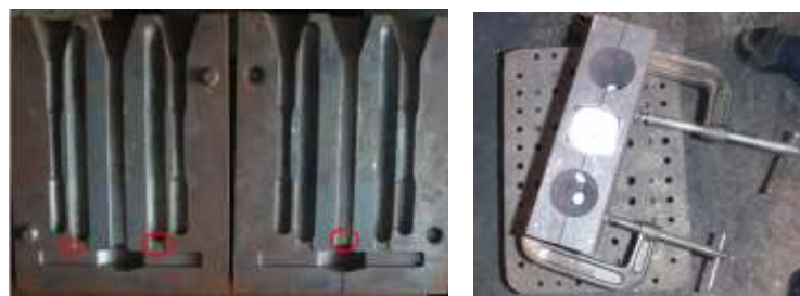
Figura 4. Molde para fabricación de probetas.
