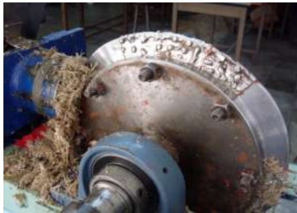
Figura 3. (a) Esquema máquina para medir desgaste. (b) Máquina para medir desgaste.
