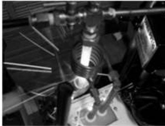
Figura 1. Obtención de cintas metálicas por la técnica Melt Spinning. Se aprecia en primer plano la bobina
