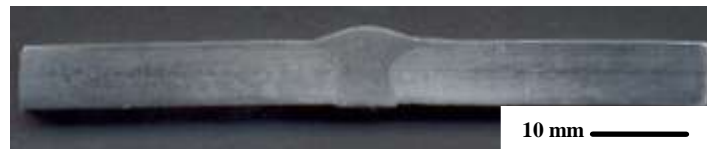
Fig. 5 Perfil del cordón de soldadura depositado con y sin la interacción electromagnética
