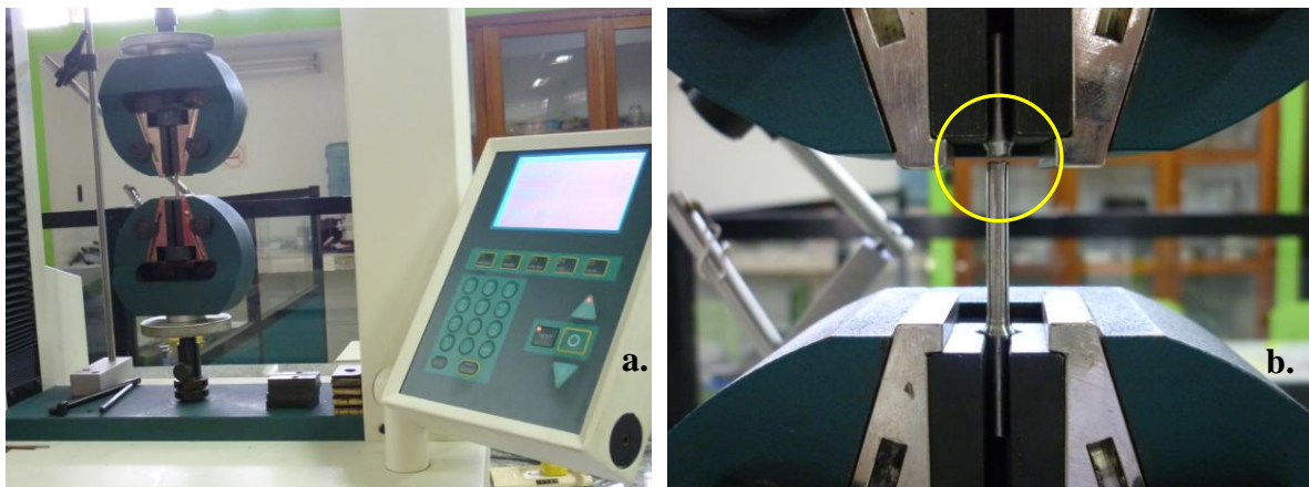
Figura 4. a. Máquina de ensayos Tinius Olsen H25KS. b. Fractura del material en el ensayo de tracción.
