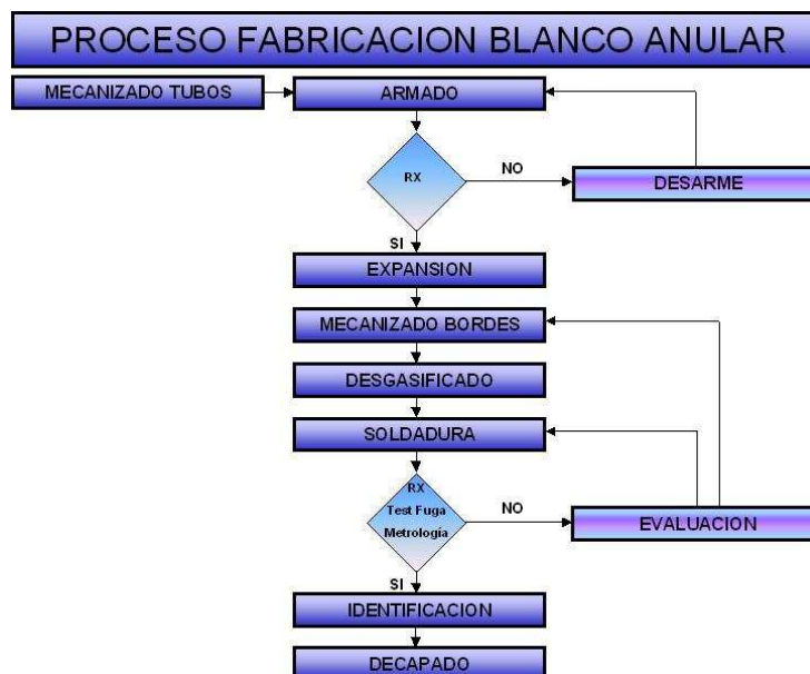
Figura 1. Procedimiento de fabricación de blanco anular.
