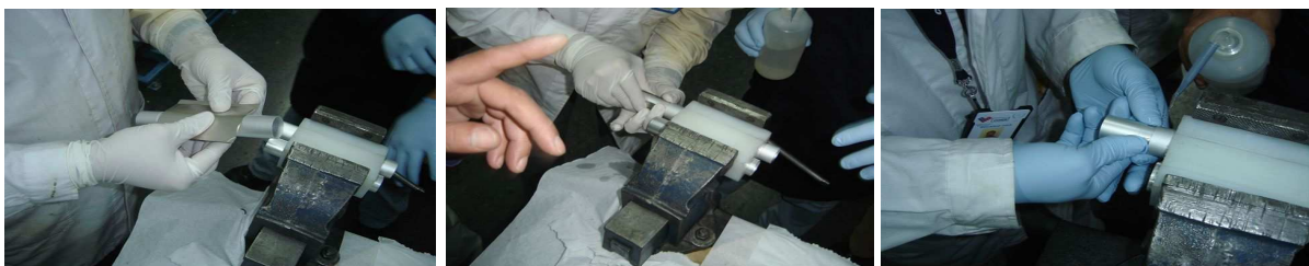
Figura 5. Secuencia de armado de blanco anular.
