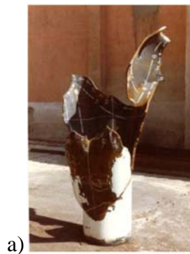
Figura 6.1. Dos de los fragmentos de rotura del recipiente. Cuerpo y ojiva (a), y cuello roscado con tapa (b). La flecha en cuello indica la zona agrietada longitudinalmente.
