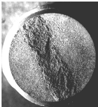
Figura 3.1. Superficie de rotura del espárrago ensayado a fatiga.
