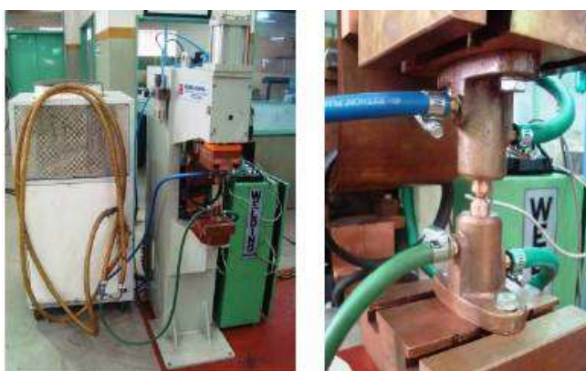
Figura 1. Equipamiento y dispositivos utilizados para soldadura por RSW.
