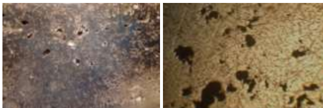
Figura 1. Macrografía de la aleación reciclada y micrografía x100. Ataque: Glycol.
