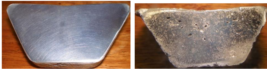
Figura 4. Macrográficas de la aleación original refundida y de la aleación reciclada a partir de las virutas.
