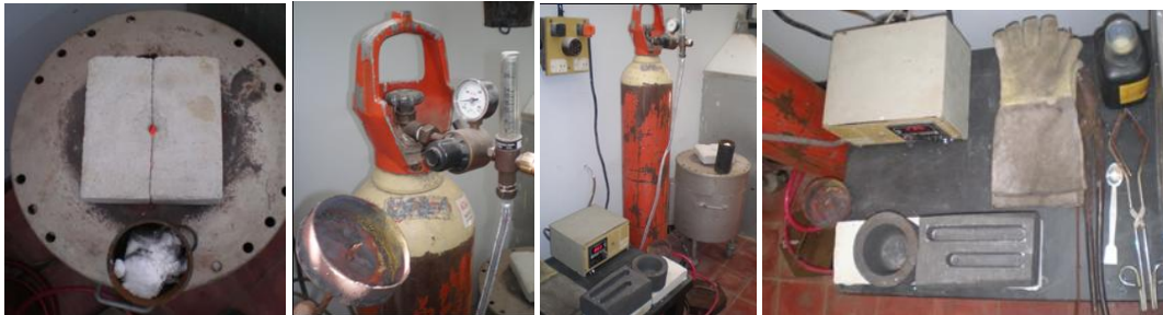
Figura 2. Dispositivos e instalaciones utilizadas para la fusión de las virutas de magnesio.
