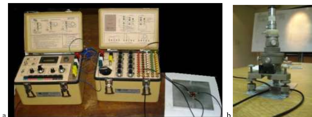
Figura 3. a- Equipo empleado y probeta instrumentada, b- dispositivo para agujero ciego.
