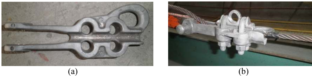
Figura 1. (a) Conector eléctrico fabricado en molde metálico y en arena y (b) ensamble del conector en un sistema de conexión eléctrica, para prueba de tracción.
