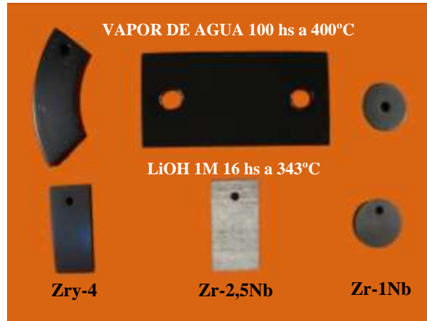
Figura 3: Aspecto superficial de las muestras de Zircaloy-4, Zr-2,5Nb (TP) y Zr-1Nb luego de 100 horas en vapor de agua a 400°C y luego de 16 horas en LiOH 1M a 343°C.
