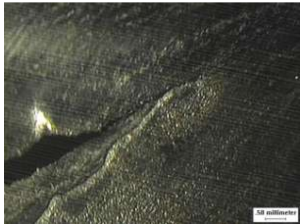
Fotografía N° 4.- Punta de la grieta con laminación.
