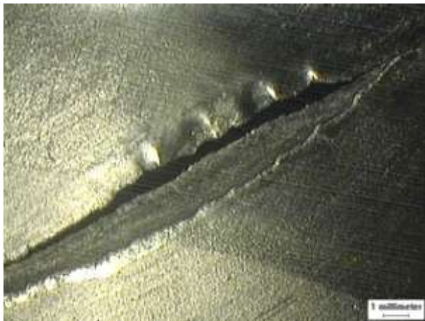
Fotografía N° 3.- Grieta con pliegues y laminación.
