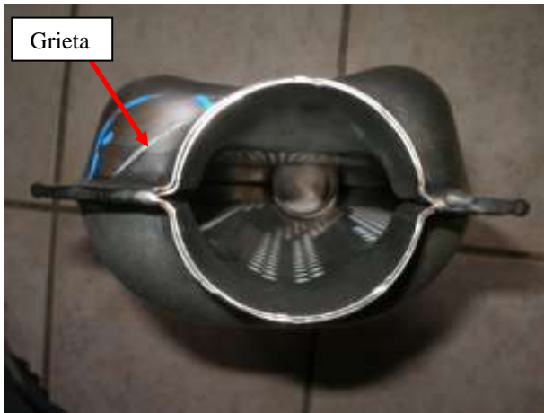
Fotografía N° 1.- Ubicación de la grieta, vista de frente.
