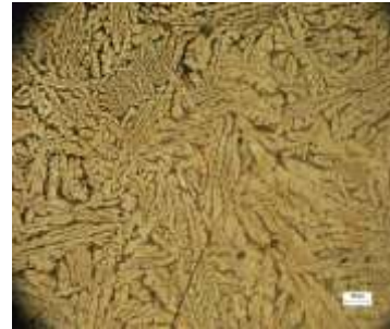
Figura 2. Dendritas del latón bifásico
