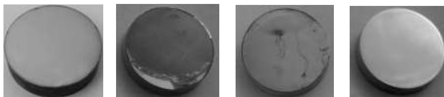
Figura 4. Probetas nitrurada, recubierta (I&D), dúplex (N+D) y patrón luego de la cámara de niebla
