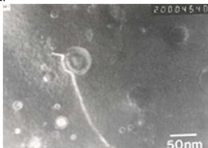
Figura 1: Micrografías electrónicas mostrando dislocaciones adheridas en los lados de salida de partículas incoherentes 6 . La dislocación se mueve desde derecha a izquierda.
