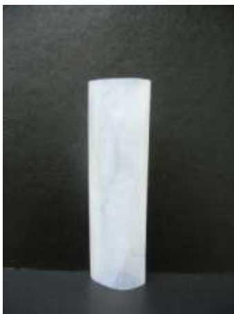
Figura 2. Film tubular de celulosa bacteriana producido a partir de residuos de la cáscara de piña.
