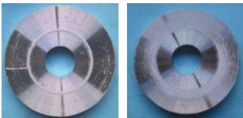
Figura 5: Imágenes de discos post ensayo con PE8 con 20 MRad efectuados con distintas cargas. Izq. 10 N. Der. 15 N.
