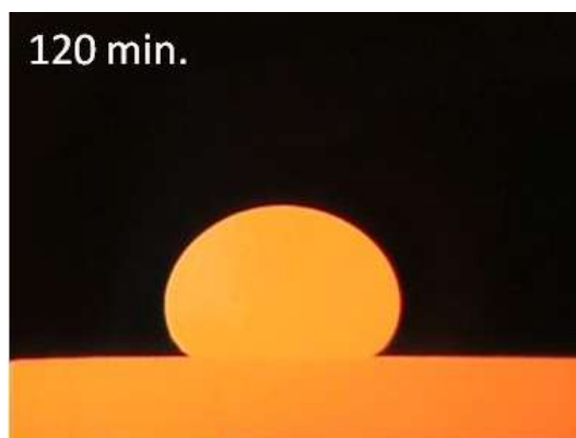
Figura 5. Sistema MR expuesto a prueba de gota estática por Al a 1100 °C.
