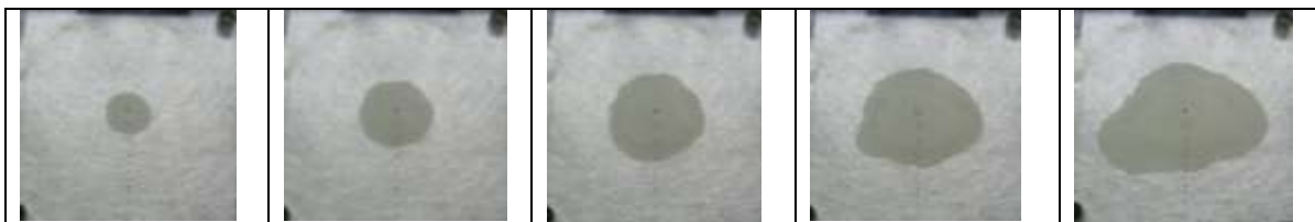
Figura 4. Secuencia de formación de una línea de avance rápido del frente de flujo.
