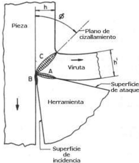
Figura 1. Fuentes de calor en la formación de viruta (según Dino Ferraresi [3]).
