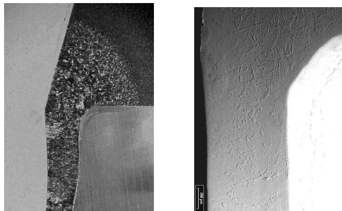
Figura 5: Macrografía e imagen SEM de una probeta soldada.
