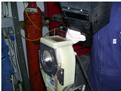
Figura 2. Equipo de soldadura orbital.
