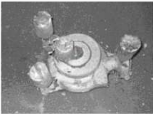
Fig 8 Pieza de bomba centrífuga fundida con la Aleación 316L.
